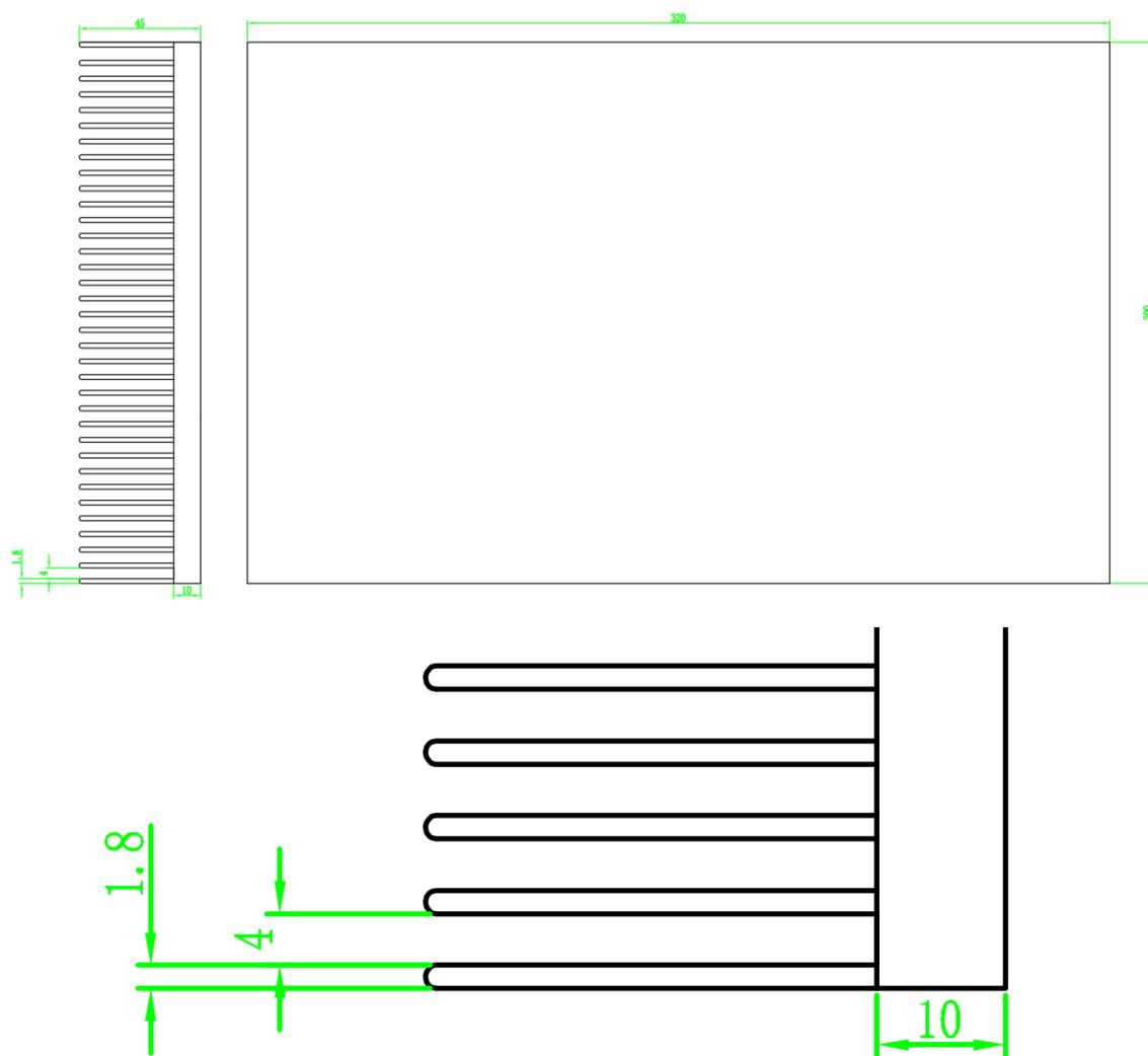
图一: Scheme for Heatsink 散热板尺寸图 (单位: mm)
